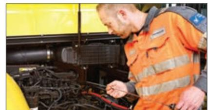
Acceso rápido para el control del aceite del motor
