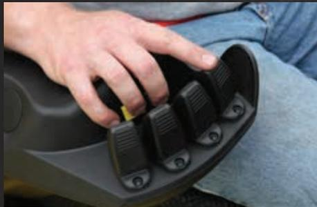
« El apoyabrazos ajustable que acompaña a las configuraciones opcionales del control sistema hidráulico electrónico TouchPoint se mueve con el asiento y se extiende telescópicamente hacia adelante y verticalmente con un solo movimiento para proporcionar una mayor flexibilidad y lograr una posición más personalizada.
